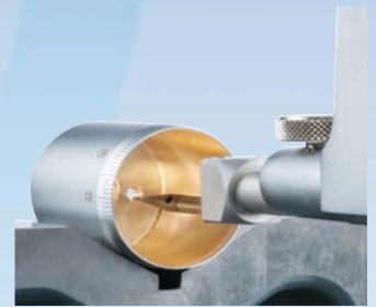
Nagyon kis furatok (~1 mm átmérőjű) precíziós interaxiális mérése MICRO-HITE-tal és a táblázatban jelzett kiegészítővel
