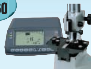
Alkalmazási példa indukzív tapintókkal és TT60-nal
